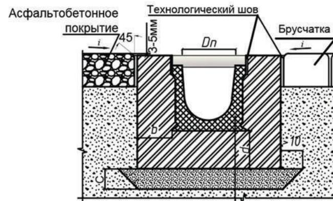
Rigolă din polimerbeton
