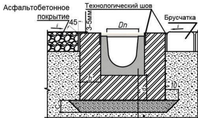
Rigolă din fibroconcret
